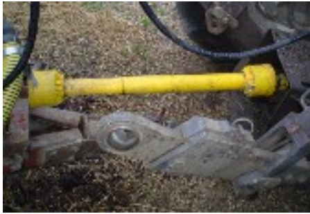
A shaft attached to a PTO Gelenkwelle (gelb), die mit der Zapfwelle eines Traktors (rechts) verbunden ist
